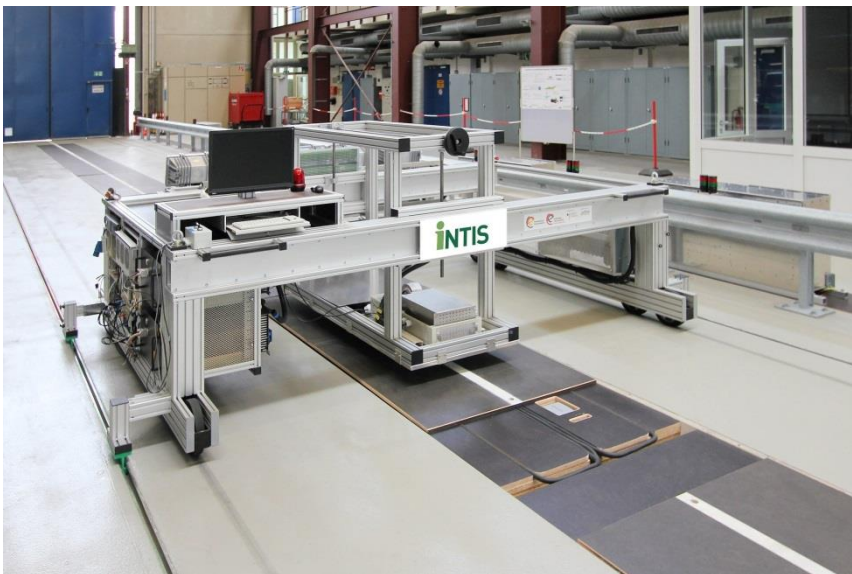
Abbildung 3 - Messrahmen zur Erprobung von Bauteilen
